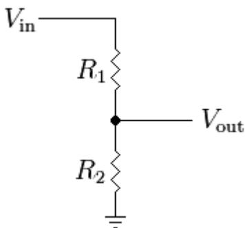
La tensión de salida del divisor resistivo se calcula como la tensión en la resistencia de salida (la que está conectada al pin de salida) en relación con la tensión total en el circuito. Esto se puede expresar matemáticamente como:
